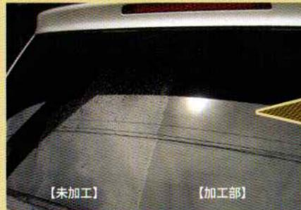
光触媒を施工すると、親水性を帯びます。この親水性は、水を馴染ませる作用があり、施工した部分へ水を掛けても水滴が出来ません。この親水性と触媒の浄化力が加わり、基材の汚れ付きを防止します。これらをセルフクリーン作用と呼びます。
